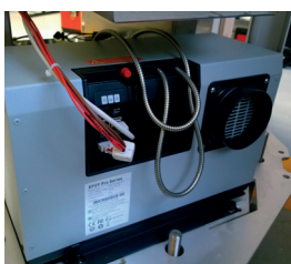
Pile à combustible
